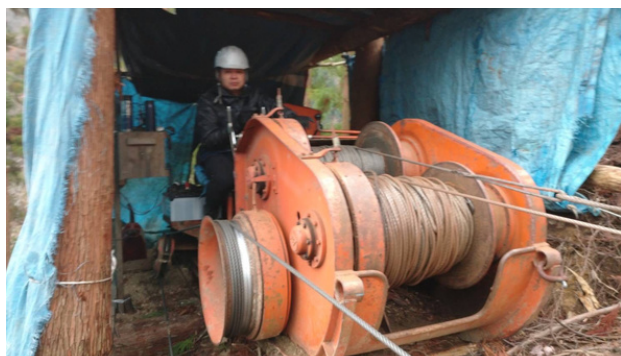
油圧集材機による架線集材
